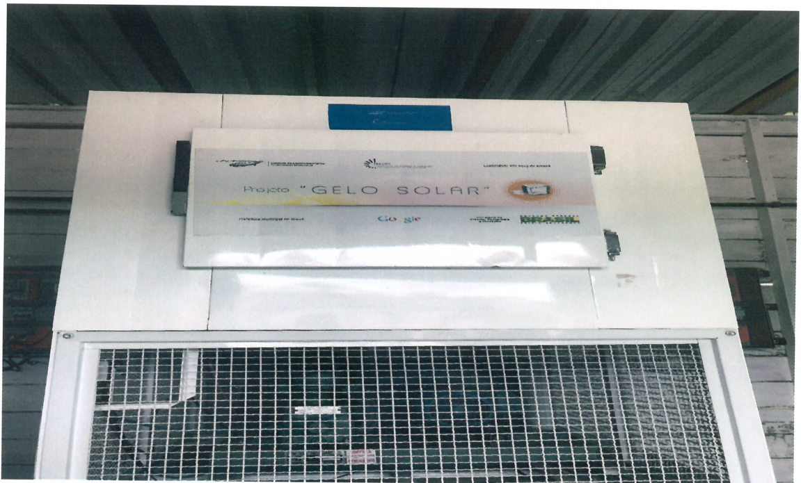
Vila Nova do Amanã (Reserva de Desenvolvimento Sustentável de Amanã): Máquina de fabricação de gelo (projetos de tecnologias sociais), alimentada por energia solar.
