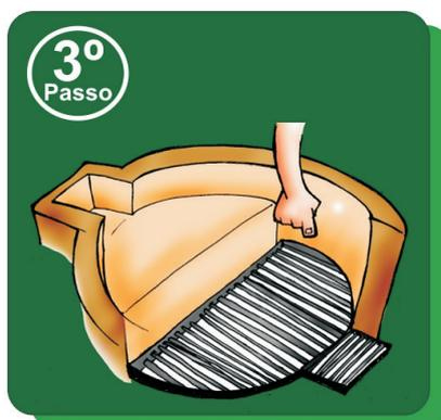
Em seguida, instale a grelha na outra metade do espaço. Após a instalação da grelha pode ser colocada a porta de ferro.
