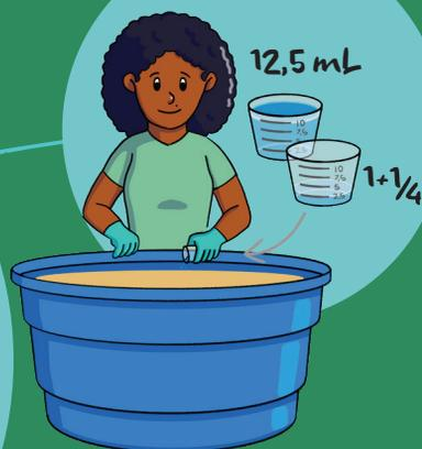
**2.** Adicione 12,5 mL de sulfato de alumínio na água (1 + 1/4 do copinho dosador).
