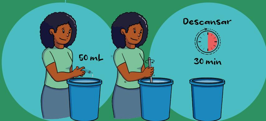
7. Se a água estiver transparente, adicione **50 mL de hipoclorito de sódio** na água coada usando a seringa medidora. Misture bem. Espere 30 minutos antes de beber a água tratada.
