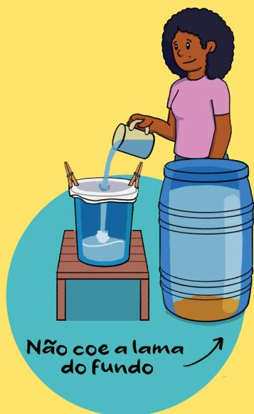
6. Você vai precisar de duas vasilhas limpas, como um balde ou uma jarra. Uma vasilha será usada para retirar a água do tanque e outra para armazenar a água que será coada com o pano. Com uma vasilha, retire do tanque somente a água limpa (ou seja, a água “branquinha”). Coloque o pano limpo e dobrado duas vezes em cima da abertura da vasilha onde será armazenada a água coada. Coe a água e tome cuidado para não coar a lama do fundo.
