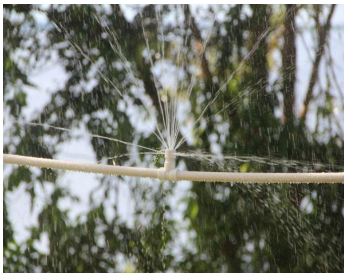
Figura 2- Laboratório de Teste do Sistema de resfriamento por aspersão montado no flutuante
